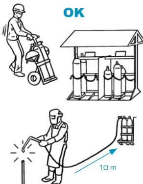
Desplazar las botellas con carretillas diseñadas para ello. Almacenarlas y transportarlas en posición vertical y sujetas, y mantenerlas entre 5 y 10 metros de distancia de la zona de trabajo. Almacenar separadas las botellas de los distintos gases. Separar también las llenas de las vacías. Evitar cualquier tipo de agresión mecánica, proyecciones o temperaturas extremas.
