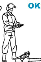
Antes de comenzar a trabajar, comprobar el buen funcionamiento del equipo y el perfecto estado de todos sus elementos, especialmente los de seguridad. Utilizar sólo espadas y cadenas recomendadas por el fabricante y en buen estado.
