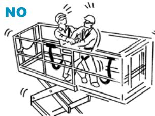
La plataforma debe ser manejada por una sola persona (autorizada por la empresa). Todos los ocupantes de la plataforma deben llevar siempre puesto el arnés anticaídas y permanecer sujetos a un elemento estructural de la propia plataforma.
