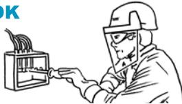
Utilizar herramientas aisladas en trabajos en tensión o en proximidad de tensión.
