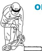
Para arrancar la máquina, apoyarla firmemente en el suelo y colocar el pie derecho en la empuñadura posterior. Verificar que la cadena no esté en contacto con ningún objeto. No arrancar el motor sosteniendo la motosierra con una mano.
