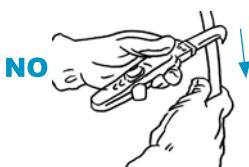
Utilizar un equipo adecuado (pelacables) y comprobar previamente que está en buen estado de conservación. Evitar el uso de navajas. Utilizar guantes con nivel 5 de protección frente al corte. No colocar nunca la mano que sujetá el cable en la dirección del corte. No adoptar posturas forzadas ni ejercer presión excesiva sobre la herramienta.
