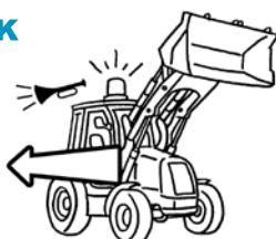
Antes de circular con el vehículo, comprobar el funcionamiento de las luces, el rotativo, el avisador acústico de marcha atrás y la bocina.
